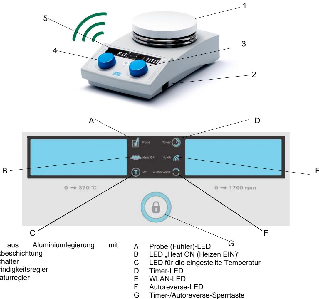
Die keramikbeschichtete Heizplatte aus einer Aluminiumlegierung (1) gewährleistet eine:
