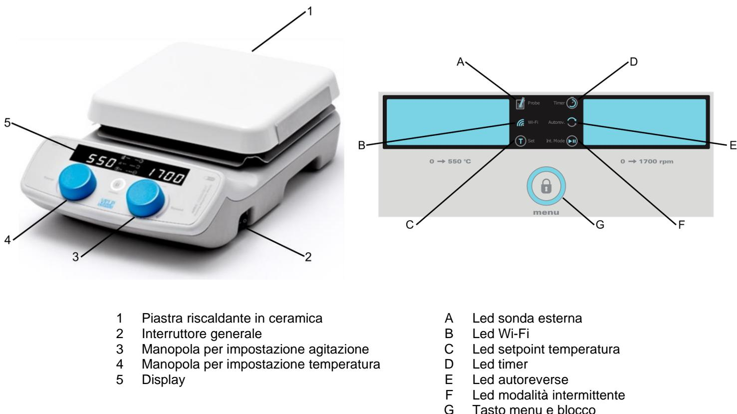
**Nota:** è importante scegliere l'ancoretta magnetica più adeguata al tipo di liquido in agitazione e al tipo di becher utilizzato. La dimensione e la forma dell'ancoretta magnetica influiscono sull'efficienza dell'agitazione. L'ancoretta che soddisfa la maggior parte delle applicazioni è la A00000356 (8 x 40 mm).
