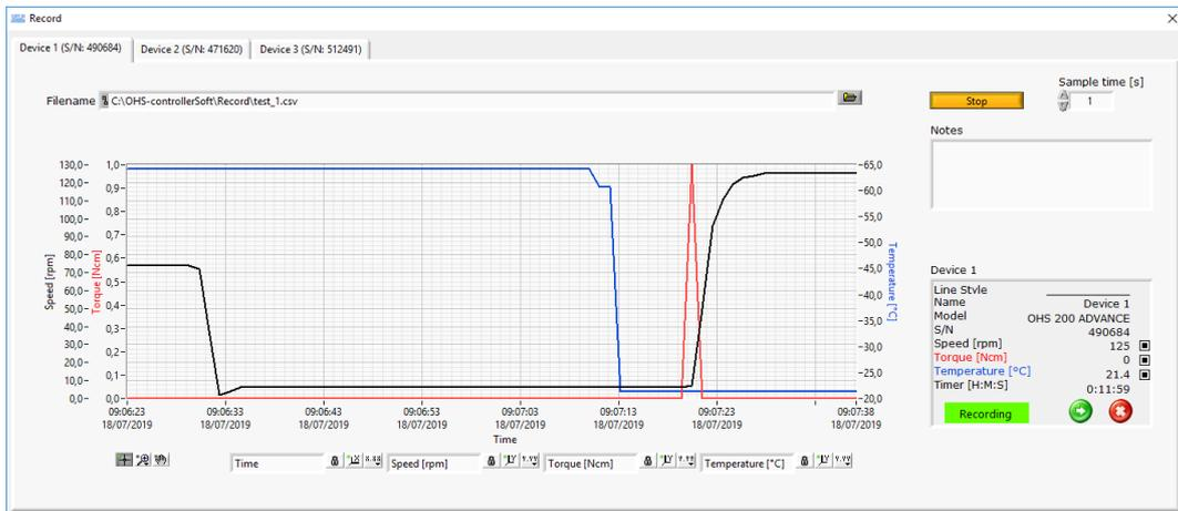
In questa pannello si trovano una schermata di registrazione per strumento per poterli gestire indipendentemente. E' possibile selezionare il tempo di campionamento, che di default è 1 secondo.
