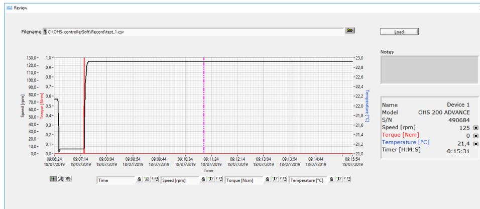
Sulla schermata principale viene visualizzato anche il tempo di funzionamento dello strumento o il countdown se settato sulla strumento stesso.
