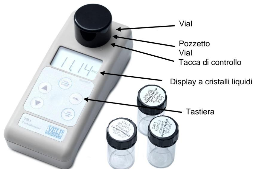
Figura 1: Parti che compongono il torbidimetro TB1
